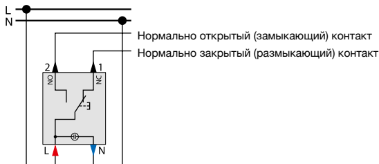
Кнопочный переключатель с зажимом нейтрали MTN3156-0000 Светодиодный модуль подсветки для клавишных/кнопочных выключателей MTN3901-00..., MTN3921-0000
